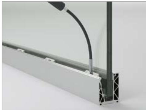
**5** Serrer le presseur pour bloquer la plaque (**serrage recommandé 2 Nm**).
