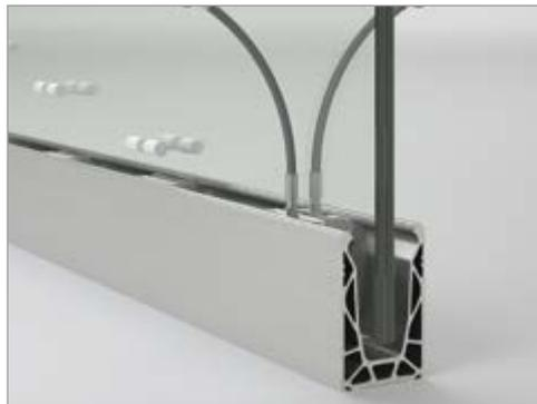
**4** Introduction des rouleaux en POM. Les rouleaux garantissent la meilleure distribution de la charge sur l'interface verre/pince/profil, en maximisant la performance du système. Réglage et serrage avec visseuse.
